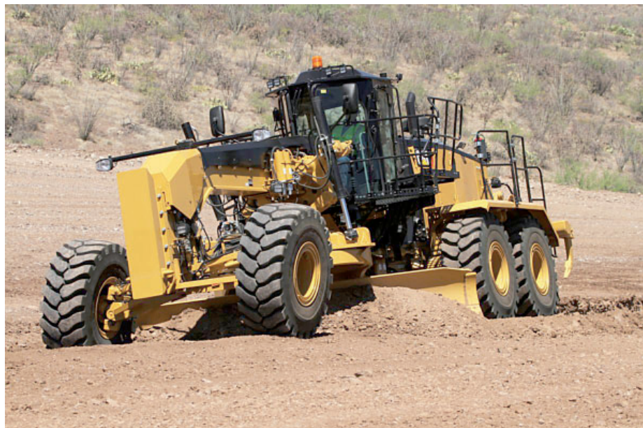
Tenhle stroj disponuje osmi rychlostmi pro jízdu vpřed a šesti pro jízdu vzad. Foto: CAT.com
