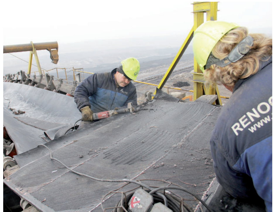
Spoje se dělají i na dopravnících přímo va velkostrojích. Takhle si gumaři připravují spoj na rýpadle K84 v lokalitě Vršany. Foto: (pim)
