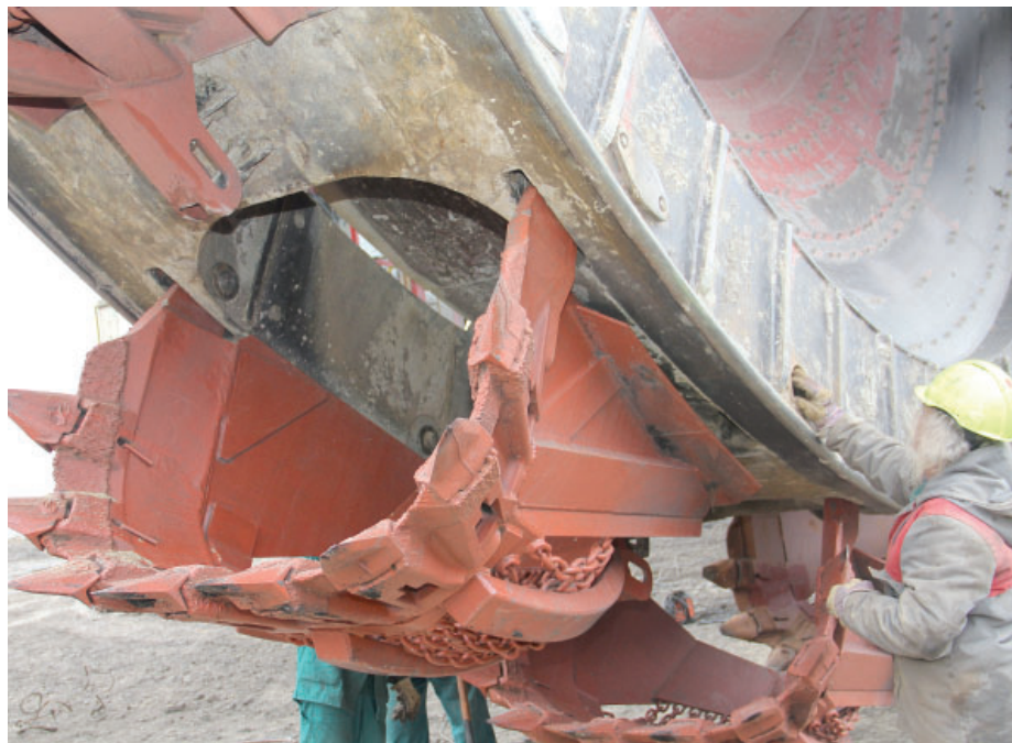
Odstávku na skrývce využili ve Vršanech ke kompletní výměně korečků na rýpadle KU800/K84. Foto: (pim)
