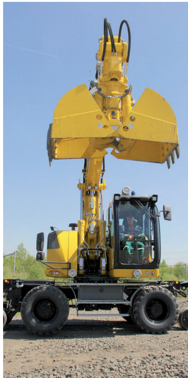
Rypadlo Liebherr má díky přídatným doplňkům všestranné využití při údržbě kolejí. Foto: (pim)
