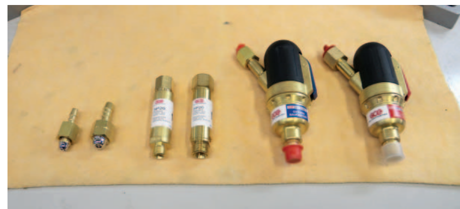
Vlevo jsou dnes už nepoužívané zpětné ventily, vedle nich oba druhy suchých předloh, které se u autogenních souprav používají. Foto: (pim)
