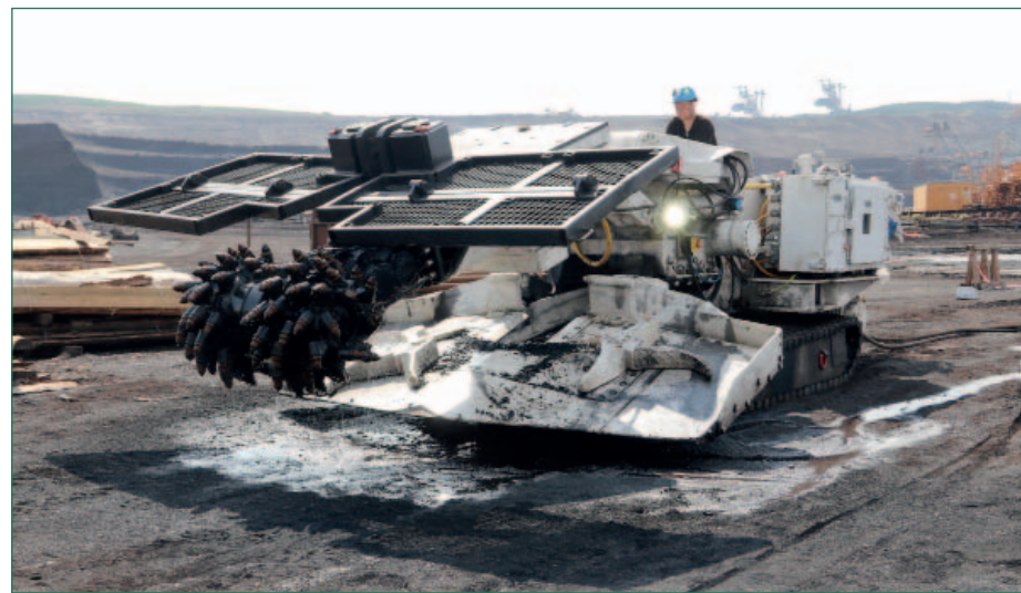
Razící kombajn má i speciální pracovní plošinu, na tomto záběru ale ještě není zcela kompletní. Foto: (pim)
