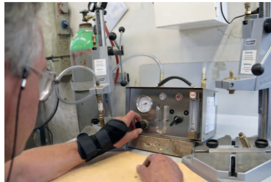
Speciální přístroj slouží ke zkoušení průchodnosti a těsnosti suchých předloh. Foto: (pim)
