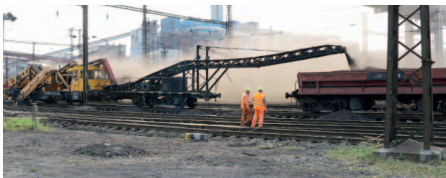
Ejhle nebo také pasadlo, jinak ale speciální vůz osazený pásových dopravníkem, přímo v akci. Foto: (pim)
