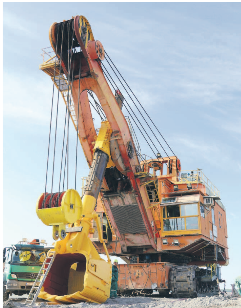
Lopatové rypadlo E7/R152 dostalo o prázdninách během střednědobé opravy novou lopatu. Foto: (pim)
