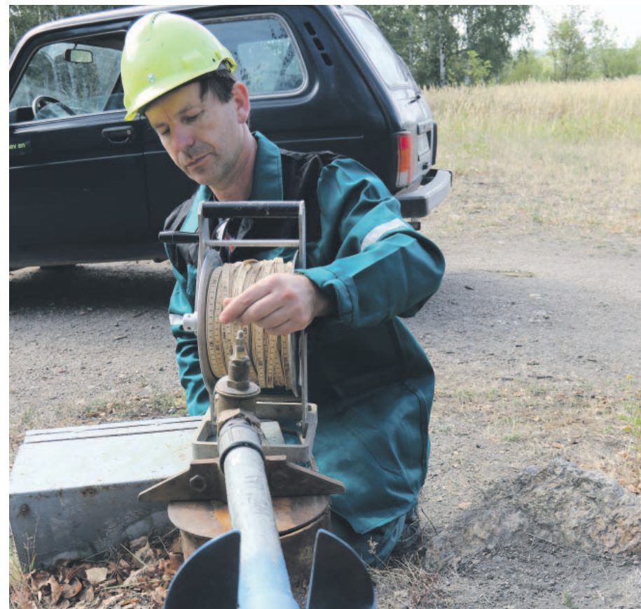
Hydrogeologické vrty v předpolí lomů se pravidelně kontrolují. Foto: (pim)
