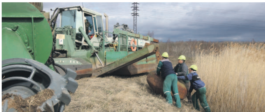
Když se bagr dopraví na místo, je třeba jej „nastrojít“, plováky se totiž převážejí zvlášť.
