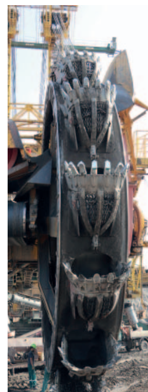
Nové korečky i zuby se zkouší na skrývkovém rypadle K84 v lomu Vršany. Foto: (pim)
