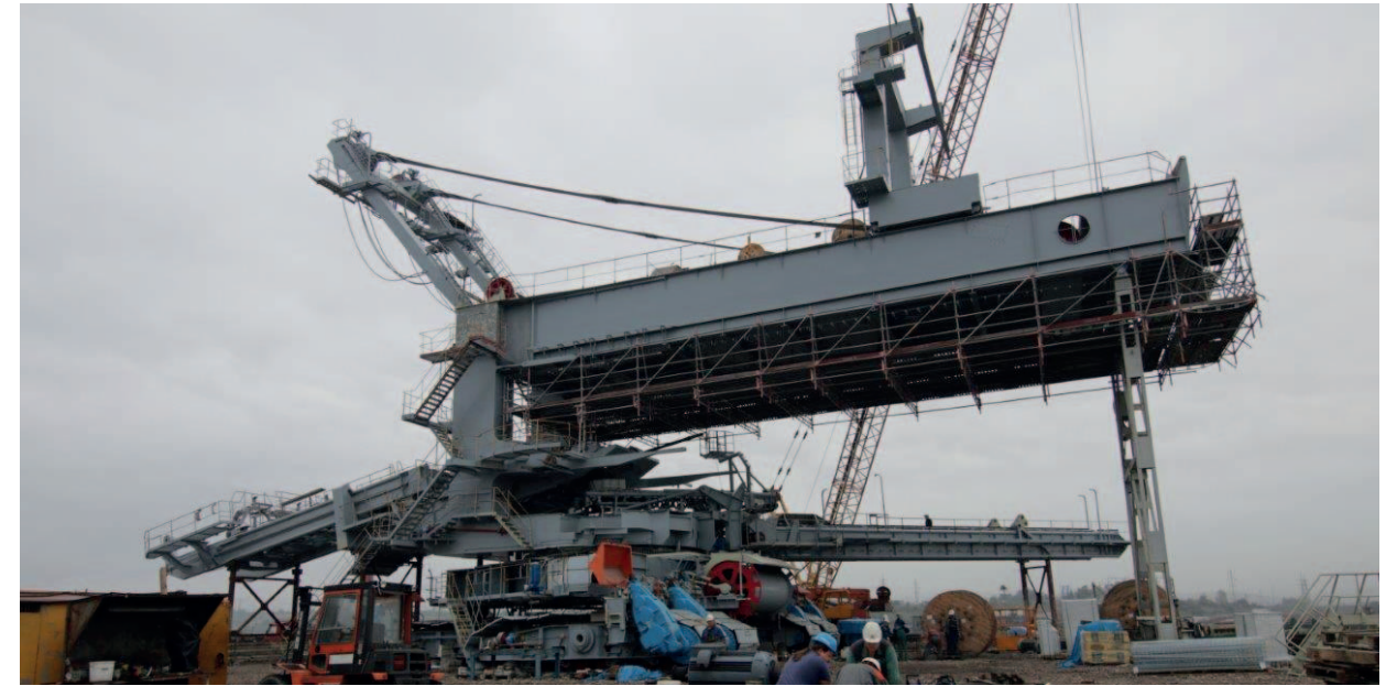
Generální oprava uhelného velkostroje ve Vršaněch pokračuje montáží velkých dílů. Foto: (pim)
